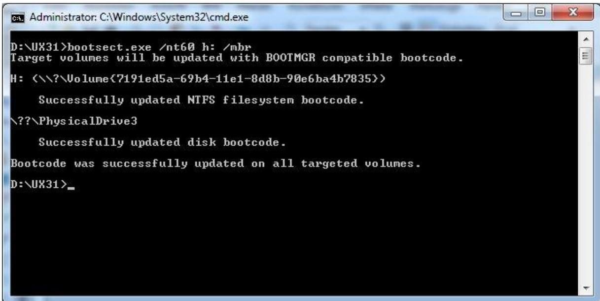
Im Anschluss an diese Prozedur kann man von dem USB Stick booten und das Recovery darüber durchführen, u.U. kann es passieren das AI Recovery nach DVD 2 (usw.) fragt in diesem Fall den Stick einmal abziehen und wieder anstecken.
